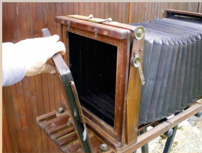
ÉTAPE 6 - RETRAIT DE LA PLAQUE PHOTOSENSIBLE POUR DÉVELOPPEMENT EN CHAMBRE NOIRE
